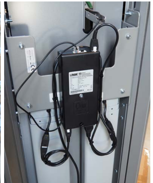
AUFGERÄUMT: Der Displayständer bietet genügend Platz für die Verkabelung. Zudem lässt sich dort auch ein Mini-PC zur Steuerung des Displays unterbringen.
