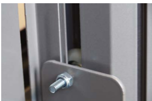
PRÄZISION: Aufgrund der kugelgelagerten Rollen bewegte sich der Laufschlitten im Test trotz des angehängten Gewichts von 120 Kilogramm mit einer großen Leichtigkeit und Laufruhe.
