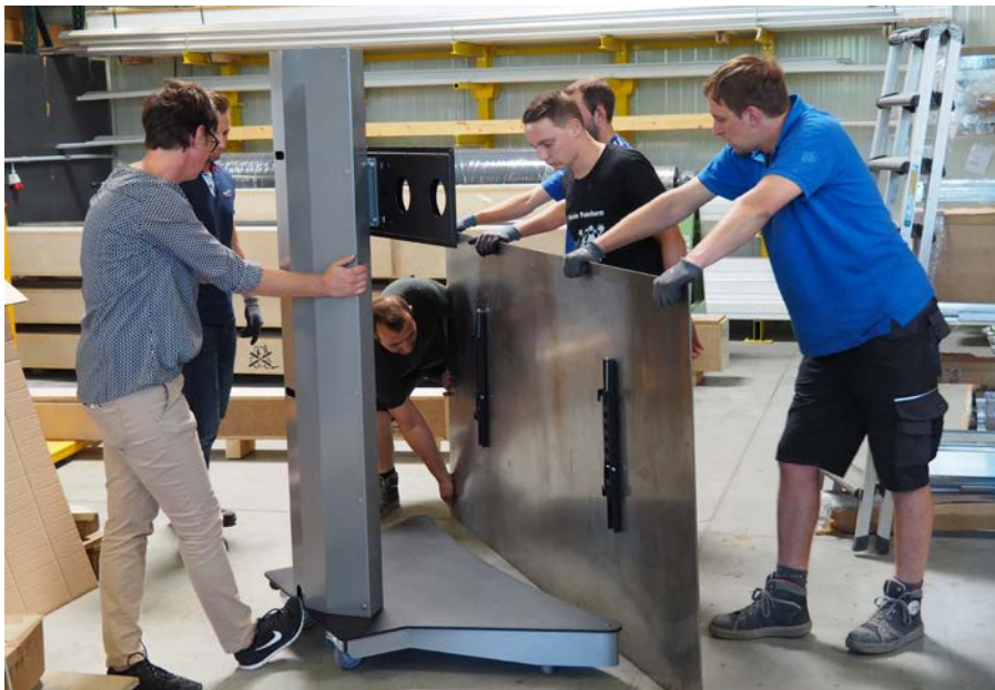
HIER WAR HILFE NOTWENDIG: Für den Belastungstest der FACTS-Redakteure haben die freundlichen Mitarbeiter von HKS Systemtechnik eine 120 Kilogramm schwere Stahlplatte an den VST-D gehängt.
